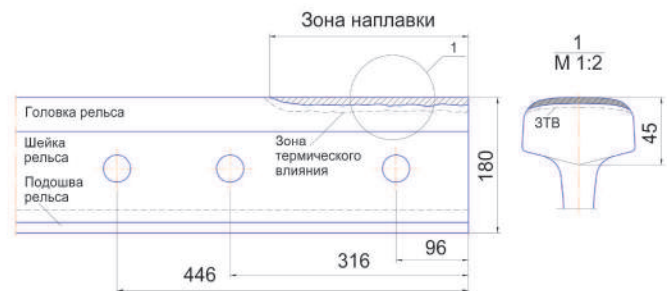
Рисунок 2 – Наплавка концов рельсов в зоне стыка
