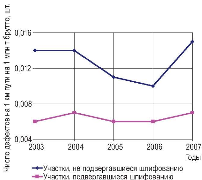
Рисунок 3 – Повреждаемость рельсов дефектами в зависимости от применения профильного шлифования
