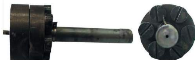
Рисунок 2 – СГПВК, на котором проводились эксперименты по исследованию восстановления массового расхода плазмообразующего газа
