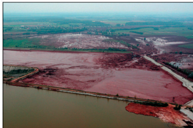
Рисунок 3 – Шламохранилище красных шламов и результат прорыва дамбы ШН в Венгрии
