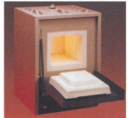
Рисунок 3 – Лабораторное оборудование для изготовления окатышей с использованием замасленной окалины ОАО «Запорожсталь»: а – фарфоровая шаровая мельница; б – тарельчатый гранулятор; в – муфельная печь
