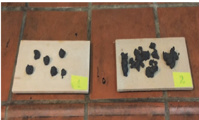
Рисунок 4 – Шарообразные и цилиндрические окатыши из шихты с использованием замасленной окалины ОАО «Запорожсталь»
