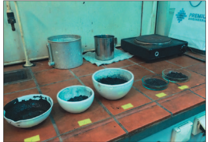
Рисунок 2 – Исходные компоненты шихты для изготовления окатышей с использованием замасленной окалины ОАО «Запорожсталь»
