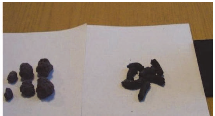
Рисунок 4 – Шарообразные и цилиндрические окатыши из шихты с использованием замасленной окалины ОАО «Запорожсталь»
