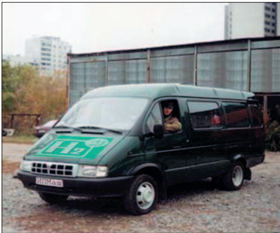
Рисунок 3 – Общий вид экспериментального образца водородного автомобиля и двигательного отсека на базе модели ГАЗ-2705
