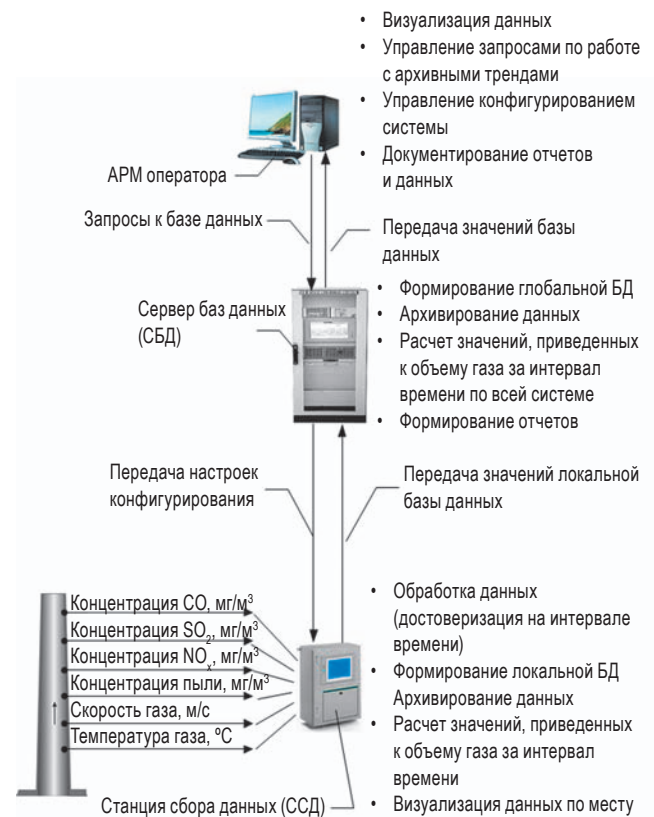
Рисунок 4 – Структура автоматизированного контроля промышленных выбросов
