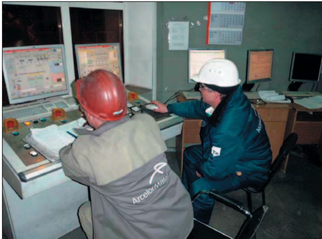
Рисунок 3 – Автоматизированное рабочее место в отделении непрерывной разливки стали конвертерного цеха
