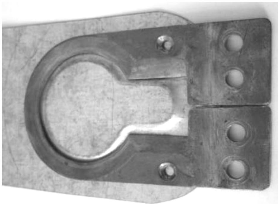
Рис.3. - Индуктор с выпуклым экраном в сборе
