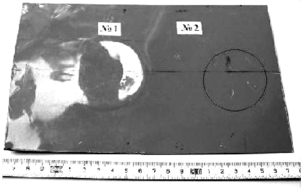
Рис.4. - Експериментальний образец листової сталі кузова автомобіля фірми "Мицубіси", №1 – исходна контрольна вмятина, №2 – результат устрати ідентичної вмятини с помошью магнітно-імпульсного притяження
