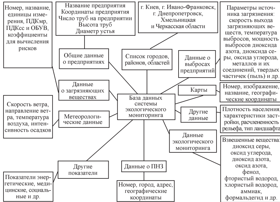
Рис. 1. Структура базы данных системы эколого-энергетического мониторинга: ПДК мр — предельно допустимая концентрация максимальная разовая; ПДК сс — предельно допустимая концентрация среднесуточная; ОБУВ — ориентировочные безопасные уровни воздействия; ПНЗ — пост наблюдения за загрязнением
