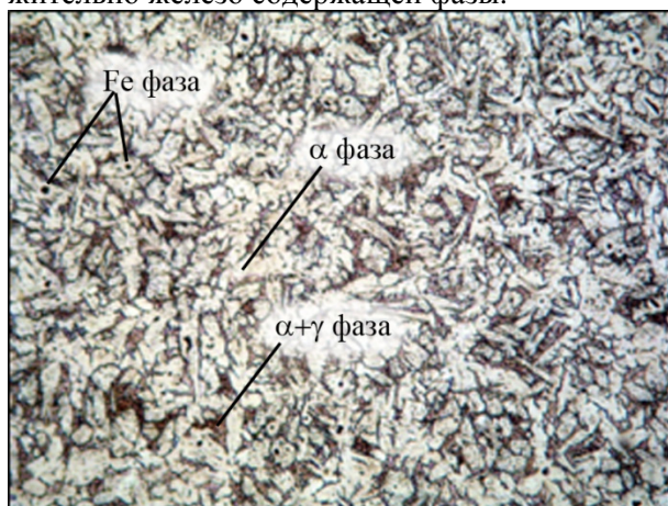
Рис. 2. Микроструктура образца №1 после литья, x500
