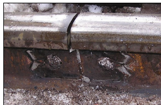
Рис. 3. Изображение шейки рельса в точке контакта с соединителем
