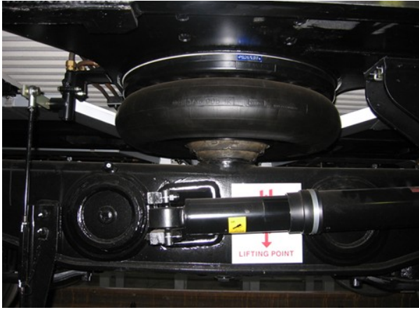
Рис. 2. Подвешивание кузова вагона на пневматических рессорах
