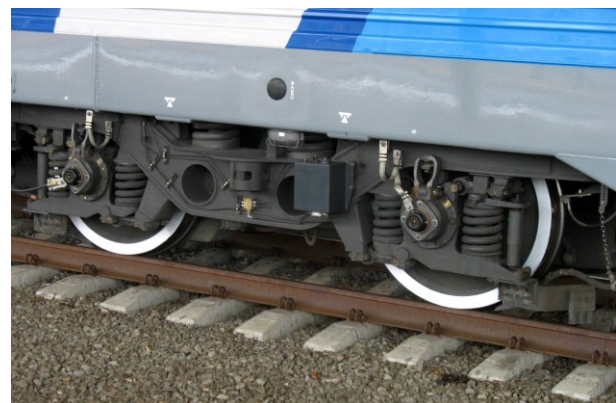
Рис. 1. Подвешивание кузова вагона на пружинных рессорах
