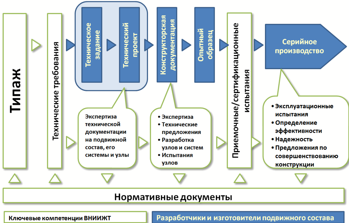
Рис. 1. Взаимодействие ОАО ВНИИЖТ с разработчиками и изготовителями подвижного состава на этапах жизненного цикла изделия
