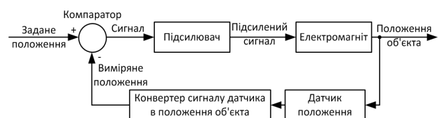
Рисунок 4 – Функціональна схема керування положенням об'єкта
