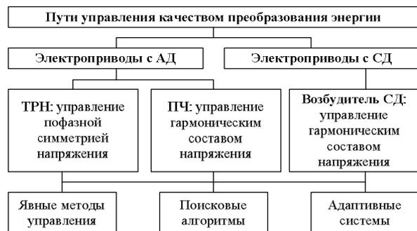
Рисунок 3 – Пути управления качеством преобразования энергии
