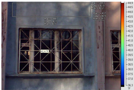
Рисунок 1 – Результати тепловізійного обстеження адміністративної будівлі навчального корпусу № 6
