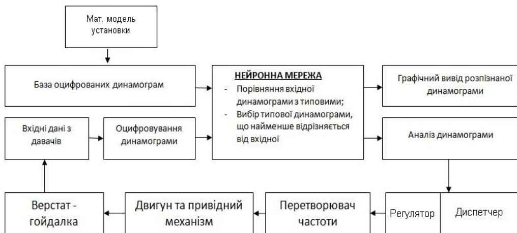
Рисунок 14 – Структурна схема системи керування ШГПУ
