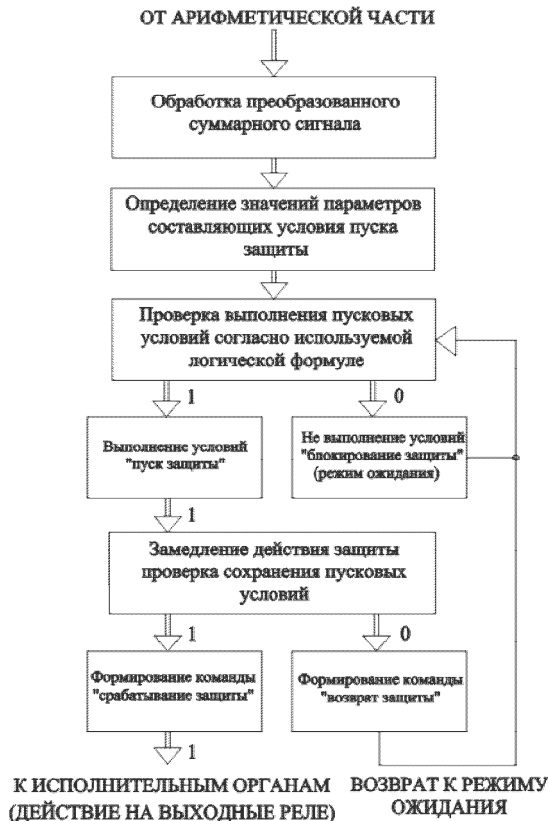
Рисунок 2 – Алгоритм функционирования органа сравнения фаз токов дифференциально-фазной защиты шин
