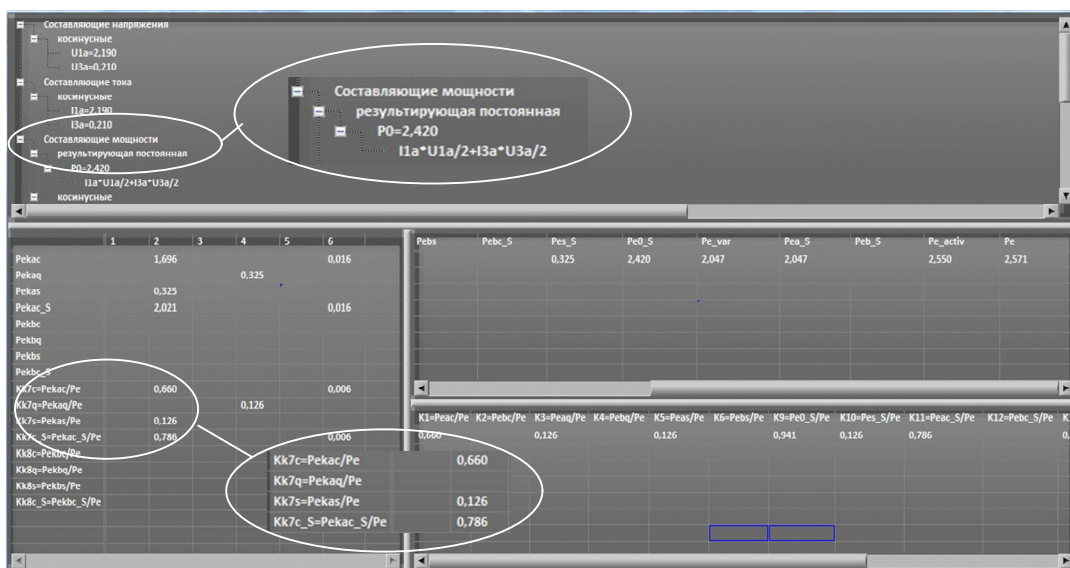
Рисунок 5 – Окно отображения ортогональных составляющих напряжения, тока и мощности, а также их среднеквадратичных оценок
