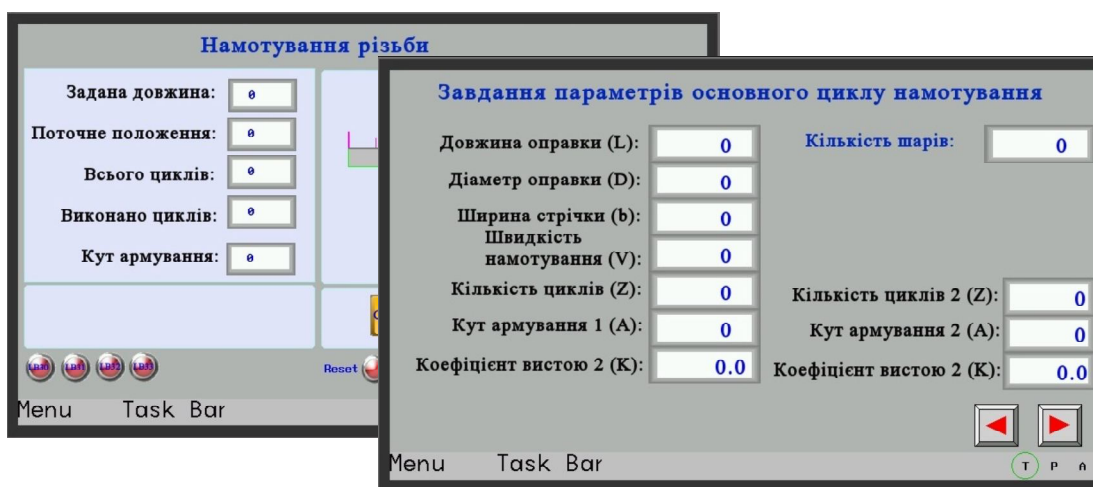
Рисунок 6 – Вікна НМИ-панелі оператора Kinco для завдання технологічних параметрів продукції та відображення ходу виконання технологічного процесу
