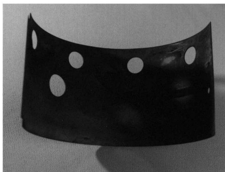
Рис. 2. Внешний вид обечайки после испытаний в продуктах сгорания топлива.
