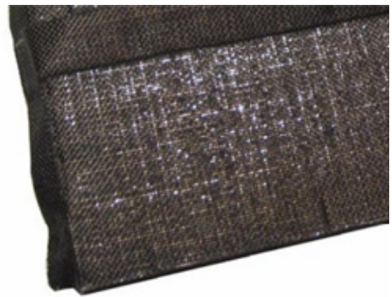
Рис. 3. Вакуумна ізоляція: a – в оболонці із склотканини; б – покриті шаром штучного каучуку
