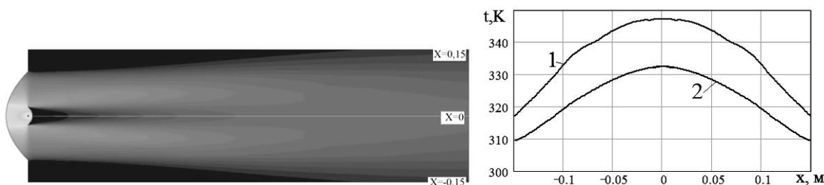
1 – схема с затеняющим отражателем; 2 – исходная схема
