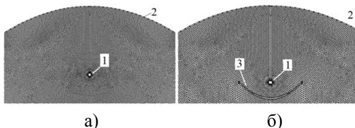
а) исходная схема; б) схема с затеняющим зеркальным отражателем; 1 – источник излучения; 2 – отражатель; 3 – затеняющий отражатель
