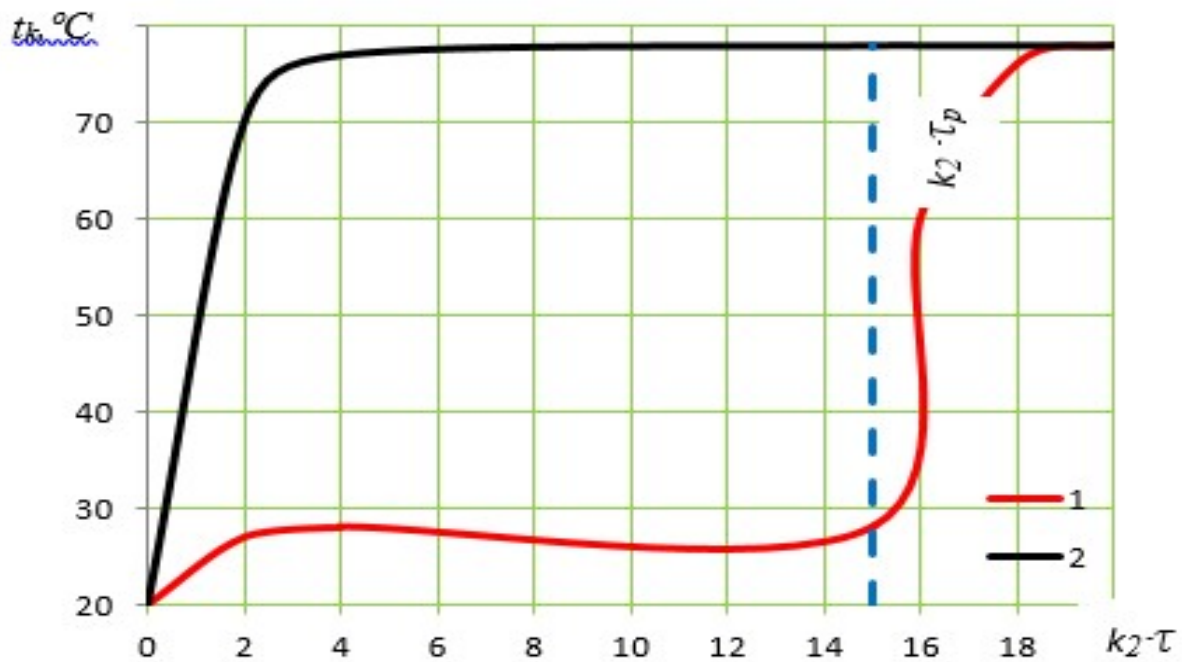
Рисунок 2 – Динаміка температури в підкостюмному просторі: 1 – із використанням теплоносія; 2 – без теплоносія
