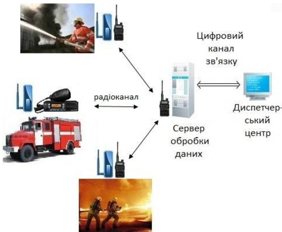
Рисунок 2 – Передача даних ПЗВІ по радіоканалам управління
