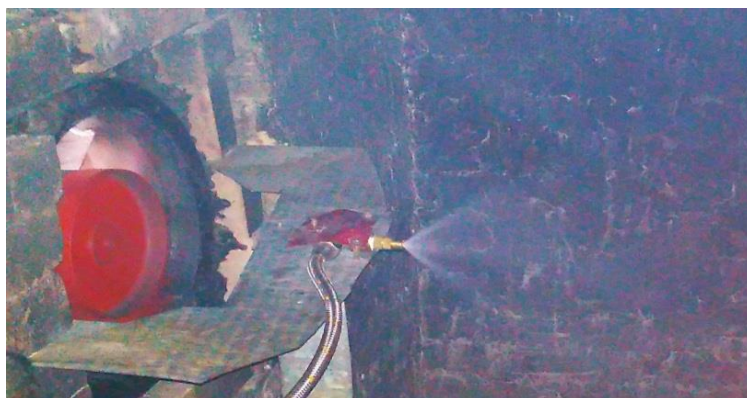
Рисунок 3 – Робота установки під час подачі повітряно-водяного струменя
