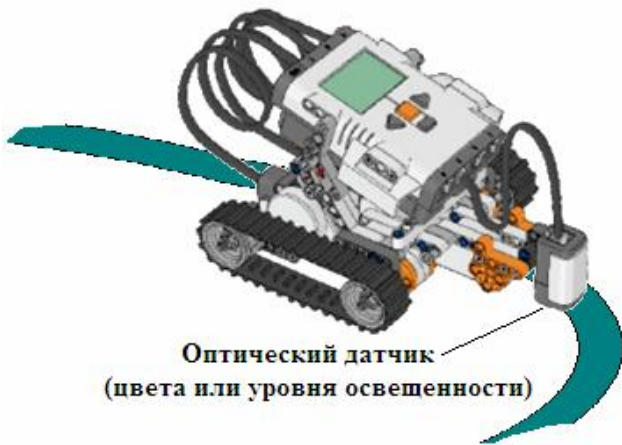
Рис. 1. Перемещение по контуру
