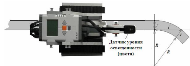
Рис. 2. Указатель движения для поворота в виде дуги в сторону контура перемещения
