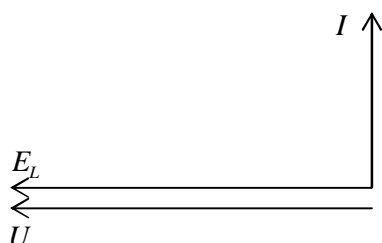
Рис. 1. Векторная диаграмма катушки индуктивности
