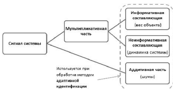
Рис. 3. Использование структуры сигнала динамической системы при обработке методом адаптивной идентификации
