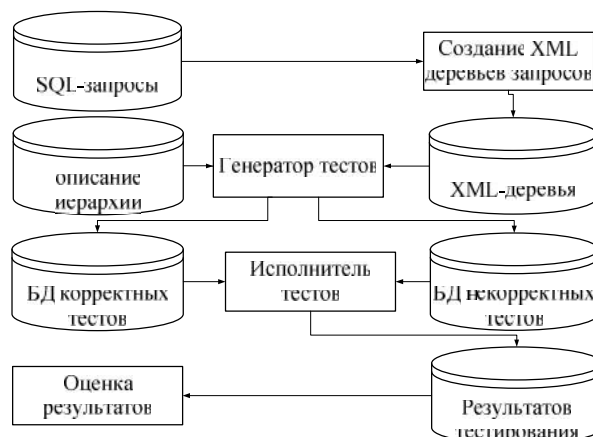
Рис. 1. Схема взаимодействия компонент системы тестирования
