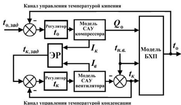
Рис. 2. Упрощенная структурная схема двуканальной САУ БХП
