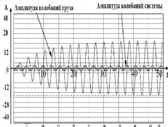
Рис. 3. График колебания груза при  $\Omega = \omega_0$
