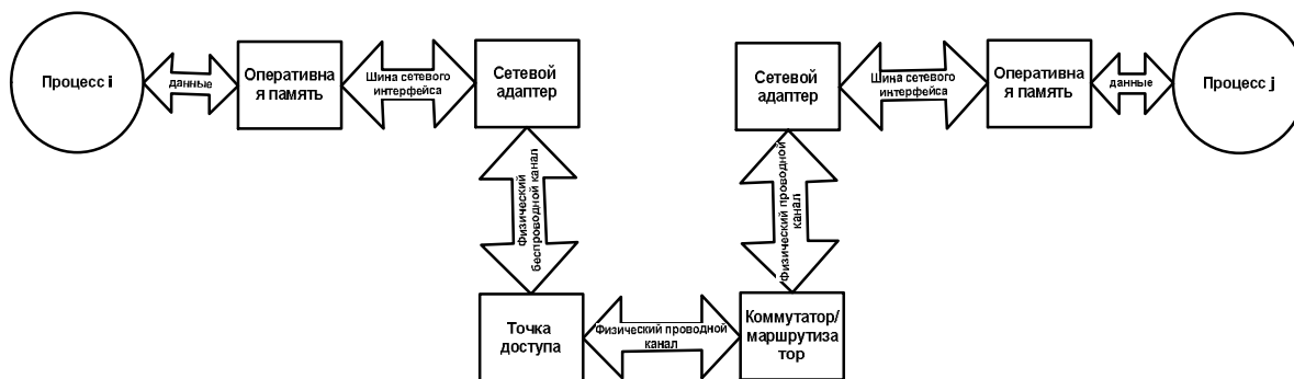
Рис. 1. Схема передачи данных по сквозному каналу гетерогенного сегмента сети
