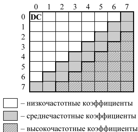
Рис. 1. Стандартное разбиение блока изображения в пространстве ДКП
