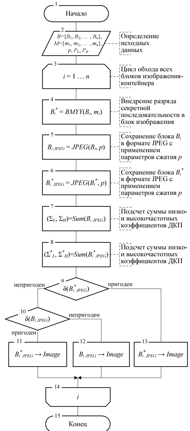
Рис. 2. Блок-схема предлагаемой апостериорной процедуры классификации блоков при встраивании
