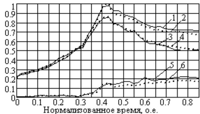
Рис. 2. Изменение мощности ЭТКГ, ПГ и потерь при графитации заготовок электродов:
