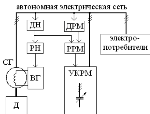
Рис. 1. Функциональная схема автономной электроэнергетической установки с компенсацией реактивной мощности:
