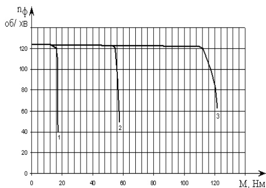
Рис. 4. Механічні характеристики БУМК-2,5 в режимі обмеження струму
