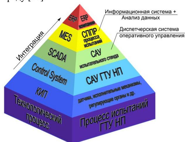
Рис.1 «Пирамида автоматизации» процесса испытаний ГТУ НП
