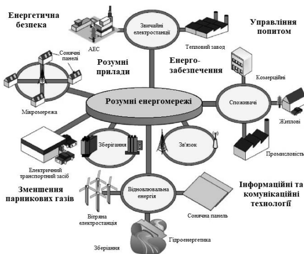
Рис. 1. Структура розумної електромережі [16]
