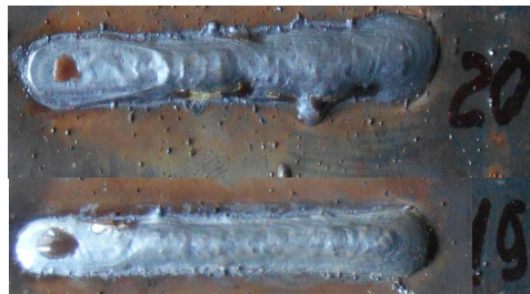
Рис. 7. Характерные валики наплавки, полученные при использовании различных способов регуляторов подачи электродной проволоки: 19 – с прогностическим регулятором; 29 – с обычным регулятором
