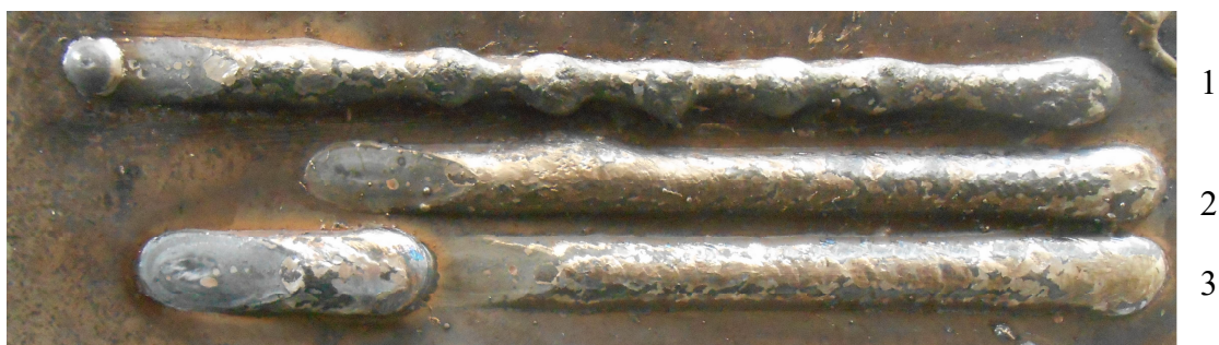
Рис.2. Наплавленные валики при механизированном процессе: 1-обычная подача; 2, 3- с применением процесса с дозированной подачей
