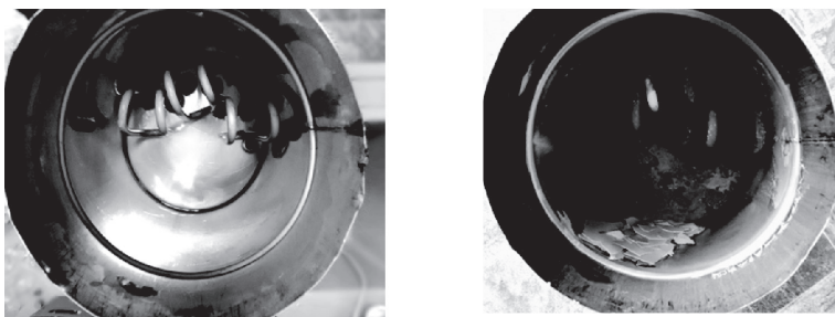
Рис. 3. Внутрішня поверхня перегонного куба дистиллятора ДЕ-10 (зліва – свіжоочищена, справа – після 150 год роботи)
