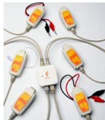
Рис. 7. Підключення датчиків до реєстратора даних NOVA Link
