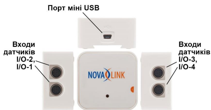
Рис. 7. Підключення датчиків до реєстратора даних NOVA Link
