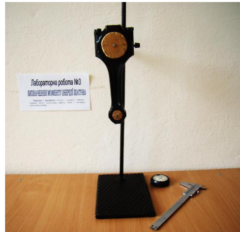
Рис.2. Лабораторна робота «Визначення моменту інерції шатуна»
