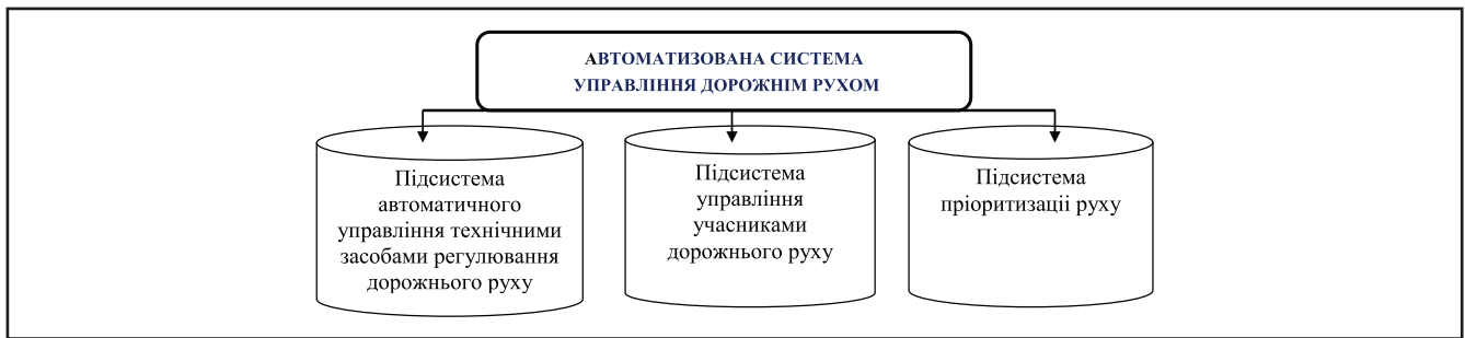
Рисунок 1. Елементи автоматизованої системи управління дорожнім рухом
