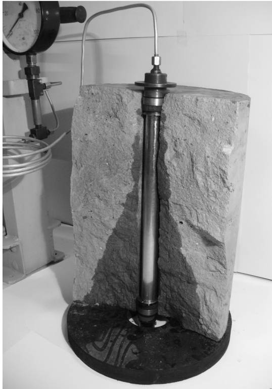
Рис. 3. Розкол циліндричної бетонної моделі безкорпусним гідроагрегатом
