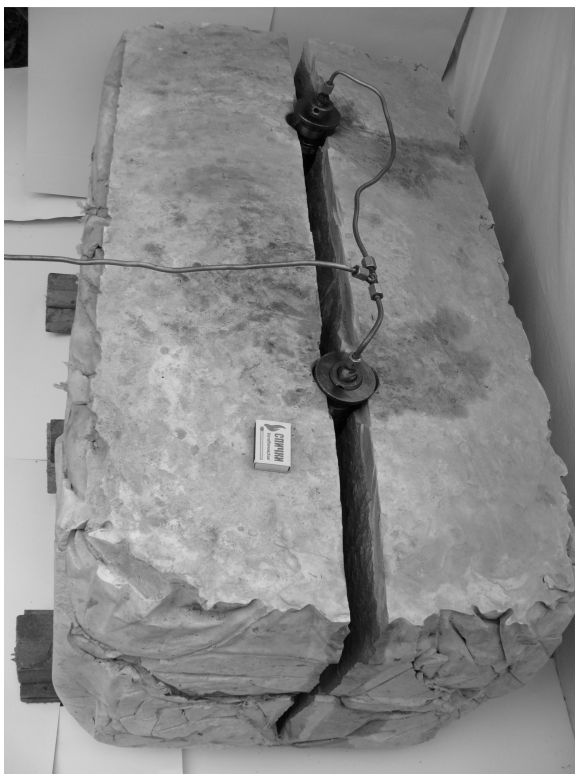
Рис. 4. Розкол бетонної моделі-блока двома безкорпусними гідроагрегатами
