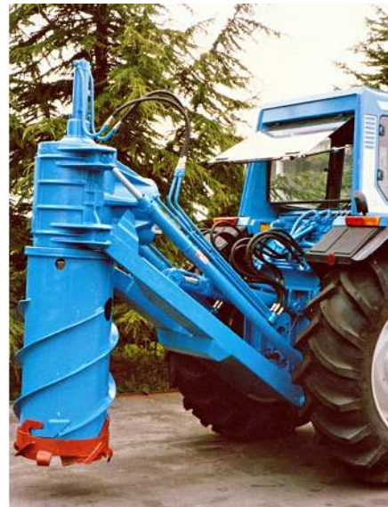
Рис. 15. Навісний ямокопач-викорчовувач фірми Elefante (Італія)
