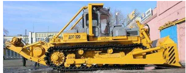
Рис. 6. Трактор ДЭТ-320 із бульдозерним та викорчувальним обладнанням
