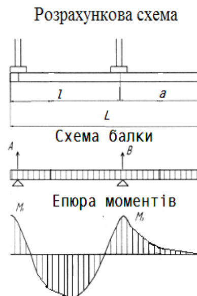
Рис.2. Розрахункова схема і еюра згинаючих моментів при максимальному зміщенні вакуум – зачепів відносно осей симетрії скла
