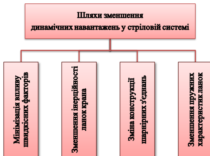
Рис. 6. Шляхи зменшення динамічних навантажень у шарнірно-зчленованій стріловій системі крана Fig. 6. Is ways to reduce dynamic loads in hinge jointed boom crane system
