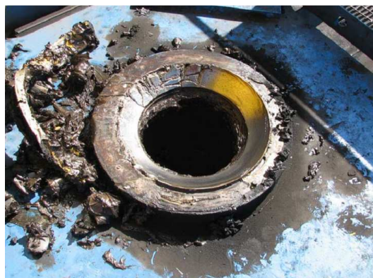
Рис. 4. Викришений упорно-радіальний підшипник
