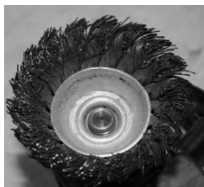
Рис. 4. Металева щітка з вигнутими дротинками
