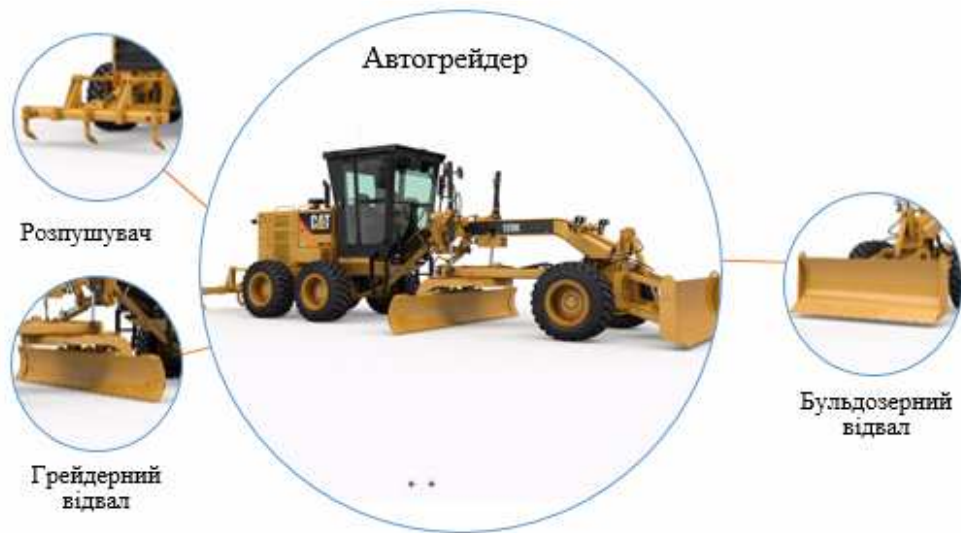
Рис. 1. Схема розташування робочого обладнання автогрейдера
