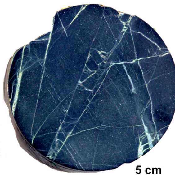
Рис. 4. Полированный штуф. Пирит светлый выполняет роль цемента в брекчированных породах. Скв. 16910, гл. 244,2 м
